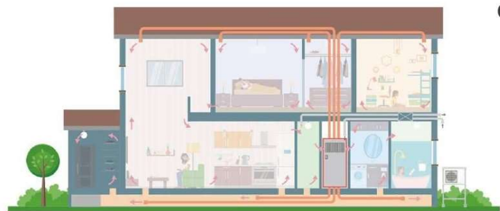
エアコン+ファンのユニットからダクトを通して各部屋に快適な空気を送る
